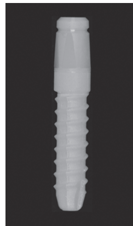
図1 ジルコニア製実験用インプラント
